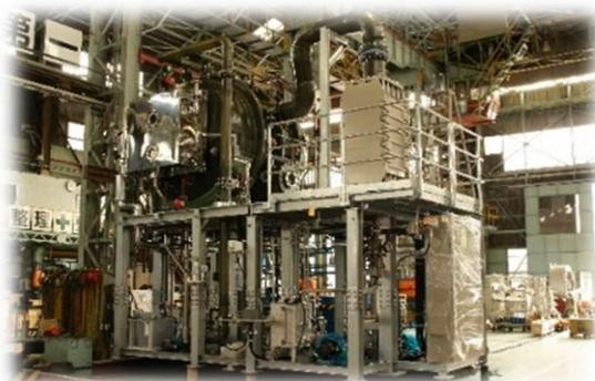
化学工業向け蒸発濃縮装置
