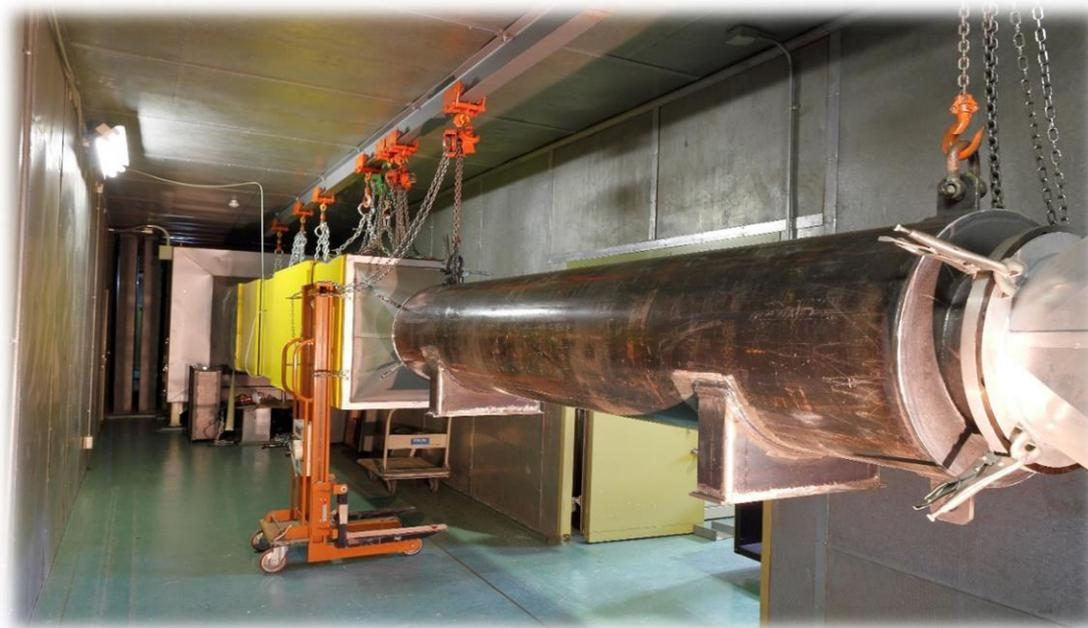
リニアサイレンサー 実機性能確認試験の様子
