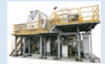
VVCC蒸発濃縮装置(MVR型蒸発濃縮装置)
