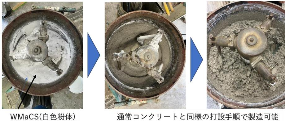
図：WMaCS を用いたコンクリート材の混練
